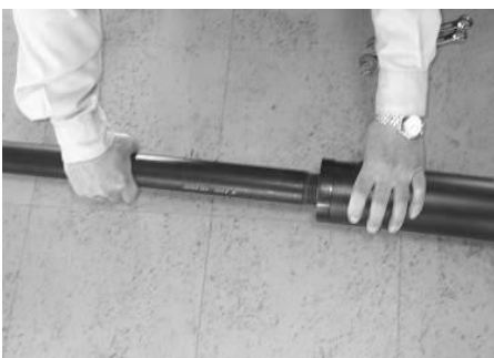
Kuva 3: Putken liittäminen sylinterin yläosaan
